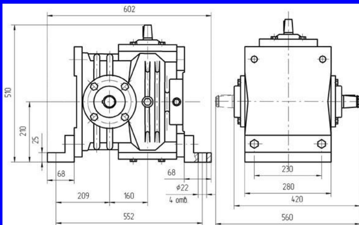
Вариант сборки 52(51,53,56,61,62,63,66), вариант крепления 5, вариант расположения червячной пары 5
