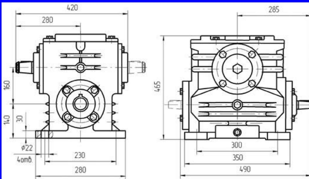
Вариант сборки 52(51,53,56,61,62,63,66), вариант крепления 1(2), вариант расположения червячной пары 1
