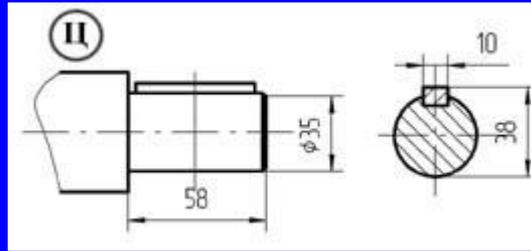
Вариант исполнения конца тихоходного вала Ц - обозначение при заказе
