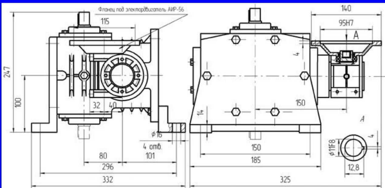
**Вариант сборки 51(52,53,56), вариант крепления 3,
